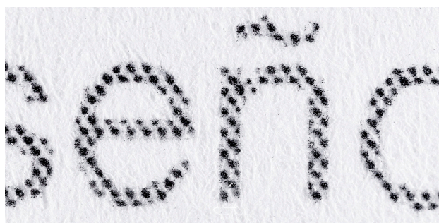
10. Debido a la limitada resolución de la xerografía, los puntos de trama son imprecisos.
